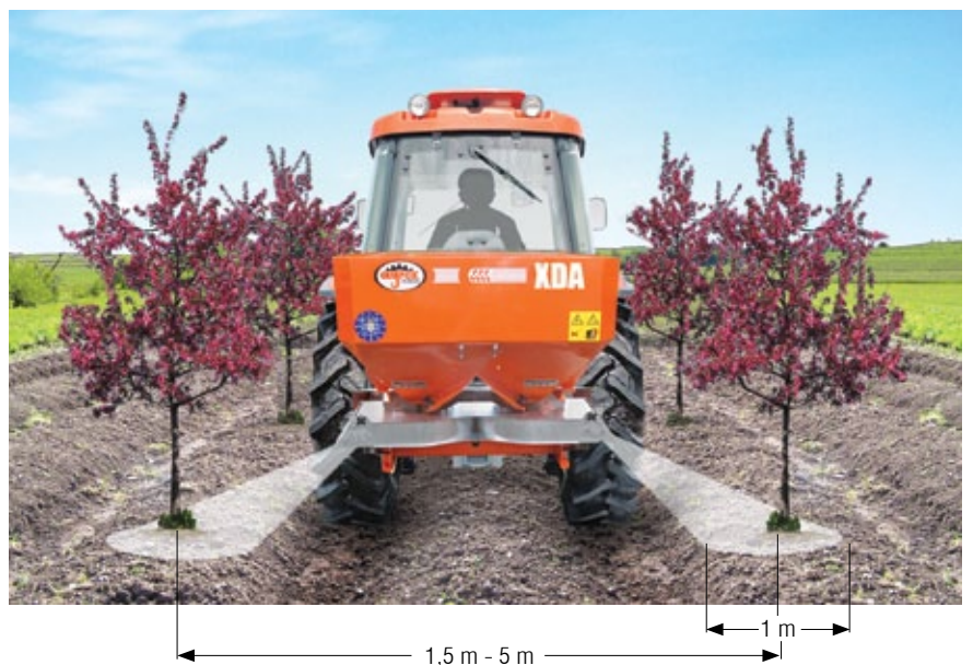
Convogliatore di spargimento bilaterale regolabile in acciaio inox
